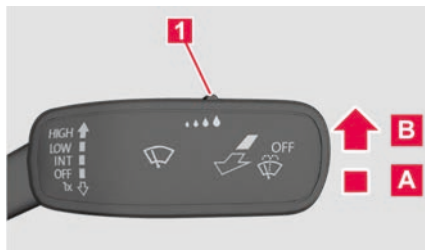
Abb. 68 An der Lenksäule rechts: Scheibenwischerhebel.
