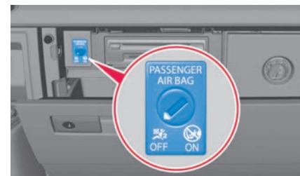
Abb. 32 Im Handschuhfach: Schlüsselhalter zum Aus- und Einschalten des Beifahrer-Frontairbags.
