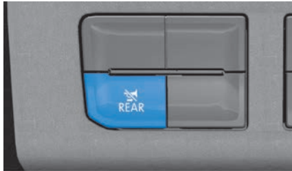
Abb. 107 Im unteren Teil der Mittelkonsole: Taste für die Rückfahrwarnanlage.
