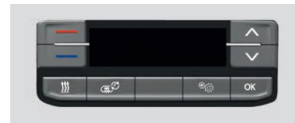
Abb. 74 In der Dachkonsole vorn: Klimazeile für den hinteren Fahrgastraum.
