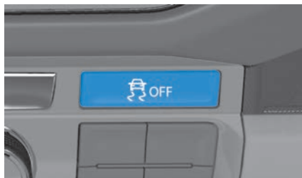
Abb. 120 In der Mittelkonsole: Taste zum manuellen Aus- und Einschalten von ASR.
