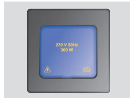
Abb. 127 Seitlich am Fahrersitz: 230-Volt-Schutzkontakt-Steckdose (Prinzipdarstellung).
