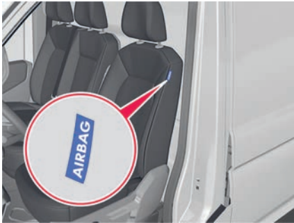
Abb. 36 Seitlich im Vordersitz: Einbauplatz des Seitenairbags.
