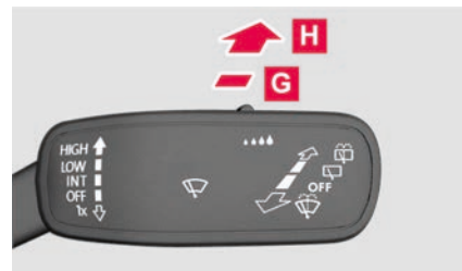
Abb. 67 An der Lenksäule rechts: Heckscheibenwischer bedienen.
