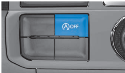
Abb. 86 Im oberen Teil der Mittelkonsole: Taste für das Start-Stopp-System.
