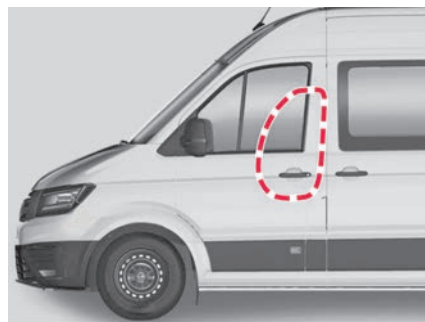
Abb. 35 Auf der linken Fahrzeugseite: Entfaltungsbereich des Seitenairbags.
