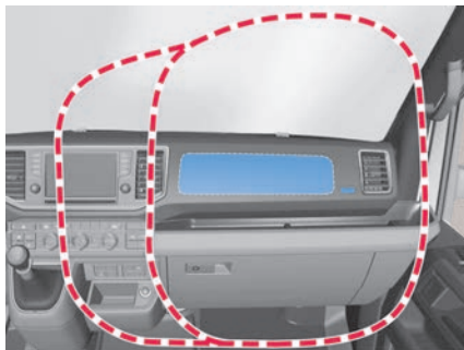
Abb. 31 Einbauort und Entfaltungsbereich des Beifahrer-Frontairbags (Prinzipdarstellung).
