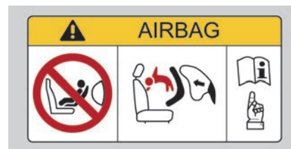
Abb. 39 Prinzipdarstellung: Airbag-Label an der Sonnenblende.
