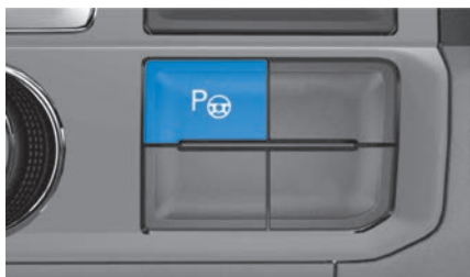
Abb. 111 Im oberen Teil der Mittelkonsole: Taste zum Einschalten des Park Assist.
