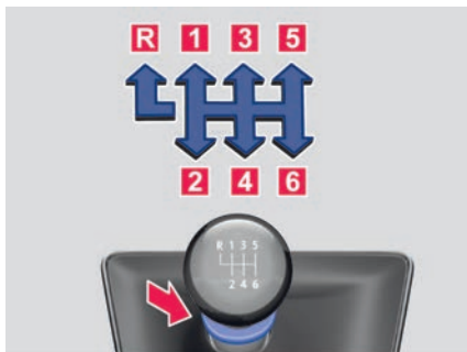
Abb. 81 Schaltschema des 6-Gang-Schaltgetriebes.
