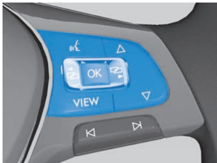
Abb. 15 Rechte Seite des Multifunktionslenkrads: Analoges Kombi-Instrument bedienen.
