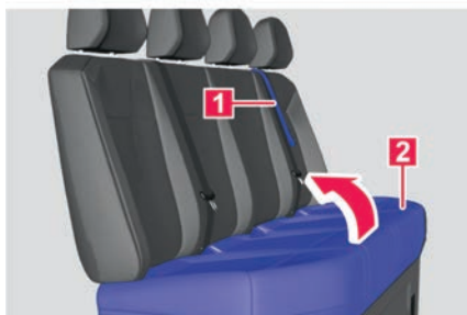
Abb. 59 An der Rücksitzbank: Sitzfläche hochklappen.
