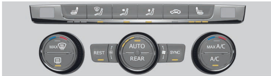
Abb. 72 Im oberen Teil der Mittelkonsole: Klimazeile der Climatronic.
