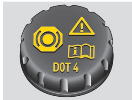
Abb. 197 Im Frontraum: Deckel des Bremsflüssigkeitsbehälters.
