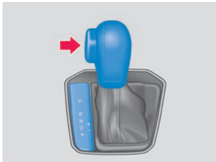
Abb. 82 Wählhebel des automatischen Getriebes mit Sperrtaste (Pfeil) beim Linklenker. Rechtslenker spiegelbildlich.
