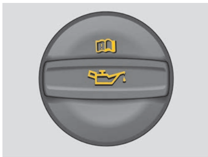
Abb. 192 Im Frontraum: Deckel der Motoröleinfüllöffnung (Prinzipdarstellung).
