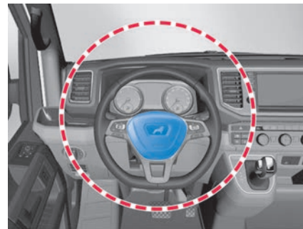
Abb. 30 Einbauort und Entfaltungsbereich des Fahrer-Frontairbags (Prinzipdarstellung).
