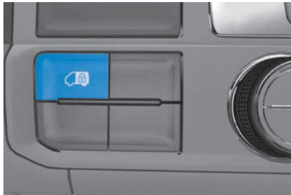
Abb. 47 In der Mittelkonsole: Taste zum Verriegeln des Laderaums.
