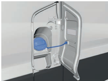
Abb. 151 An der linken Fahrzeugseite: Geöffnete Tankklappe mit Tankverschluss.
