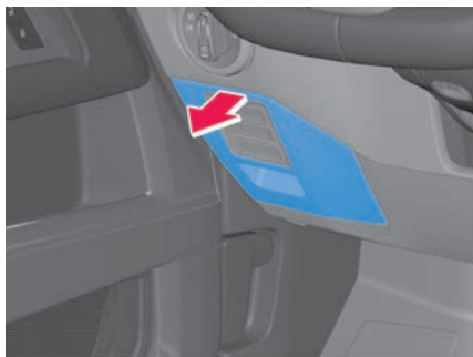
Abb. 176 Im Fußraum auf der Fahrerseite: Abdeckung des Sicherungskastens.
