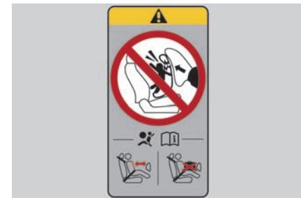
Abb. 40 Prinzipdarstellung: Airbag-Label an der B-Säule.
