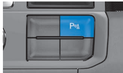
Abb. 106 In der Mittelkonsole: Taste zum Ein- oder Ausschalten der Einparkhilfe (ausstattungsabhängig).
