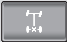
Abb. 92 In der Mittelkonsole: Taste für Differenzialsperre (Prinzipdarstellung).
