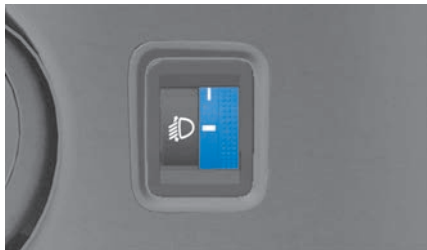
Abb. 65 Neben dem Lenkrad: Regler für Leuchtweitenregulierung.
