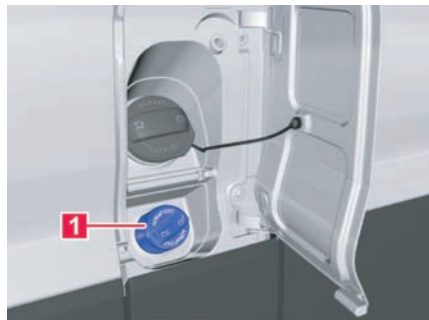
Abb. 153 Hinter der Tankklappe: Verschluss des AdBlue-Einfüllstutzens.
