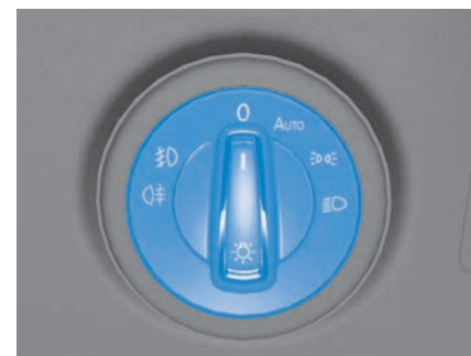
Abb. 63 Neben dem Lenkrad: Lichtschalter (eine Variante).
