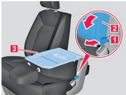
Abb. 124 Beifahrerdoppelsitzbank: Sitzlehne herunterklappen und Ablagefach in der Sitzlehne.
