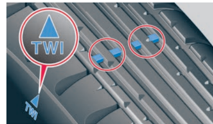
Abb. 204 In den Profilrillen: Verschleißanzeiger.
