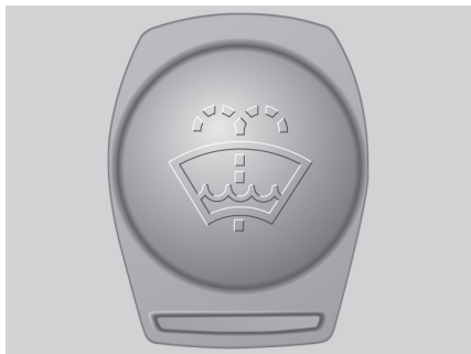
Abb. 188 Im Frontraum: Deckel des Scheibenwaschwasserbehälters.
