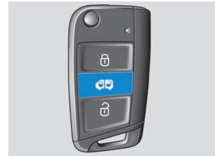
Abb. 48 Am Fahrzeugschlüssel: Taste zum Entriegeln des Laderaums.
