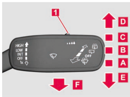
Abb. 66 An der Lenksäule rechts: Frontscheibenwischer bedienen.
