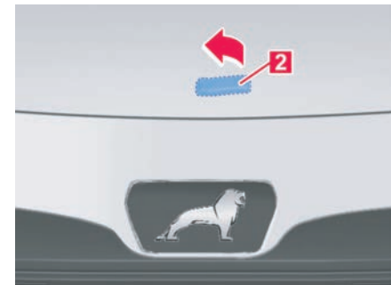
Abb. 184 Über dem Kühlergrill: Öffnungshebel für die Frontklappe.
