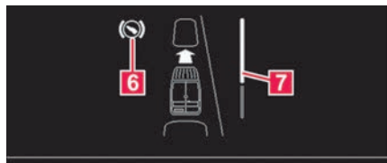
Abb. 114 Im Display des Kombi-Instruments: Fahrzeug in der Parklücke ausrichten.
