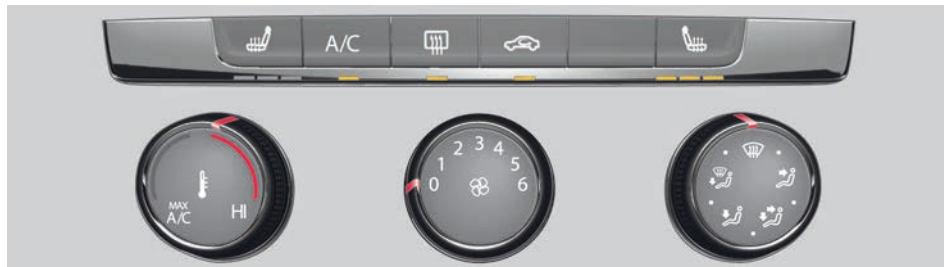
Abb. 73 Im oberen Teil der Mittelkonsole: Klimazeile der manuellen Klimaanlage oder des Heiz- und Frischluftsystems.
